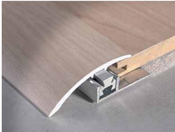
Profilo terminale brevettato per raccordare dislivelli tra 6 ÷ 11 mm. Gli elementi che compongono il sistema MULTICLIP si incastrano perfettamente tra loro grazie alla clip in tecnopoliomerio e non "grippano". Questo profilo permette di raccordare agevolmente due pavimenti non complanari. La conformazione dell'incastro tra clip e profilo consente una limitata rotazione del profilo di finitura che si conforma perfettamente al dislivello da raccordare.
